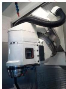
**Fräskopf mit mechanischer Spindel**, zum Fräsen schwieriger Werkstoffe wie Titan, Inconel, Edelstahl. In Verbindung mit einer Spindel mit hohem Drehmoment bei 6.000 U/min (28 kW / 1.001 Nm) ermöglicht er exzellente Schruppleistungen mit hoher Zerspanungsrate.
